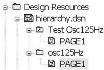
图 20.32 设置 Test Osc125Hz 为根目录原理图
