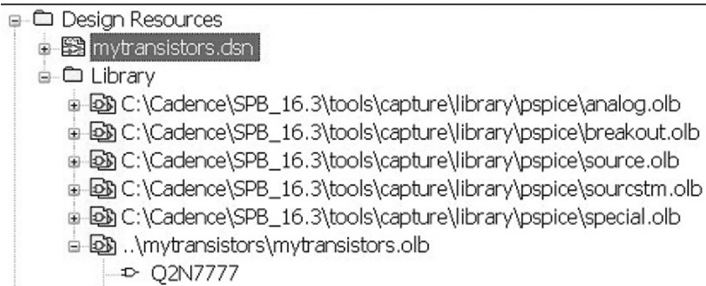
图 16.22 myTransistors 库文件和 Q2N7777 元器件
