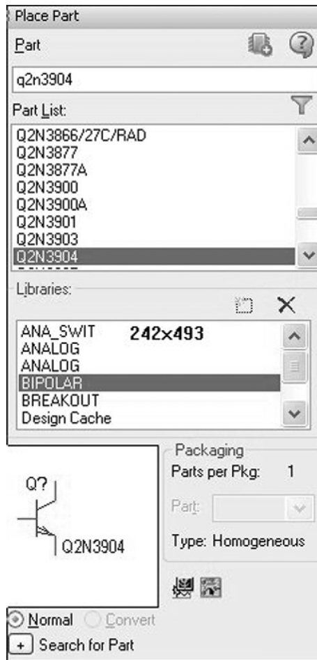
图 3.22 Q2N3904 晶体管的选取
