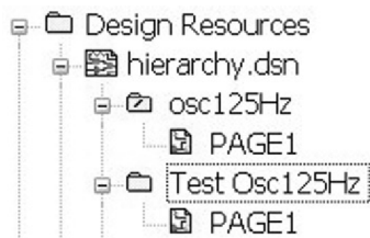
图 20.29 项目管理器中的原理图文件夹排列格式
